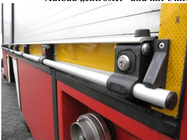
Drehstangenverschlüsse für die Rollläden sowie Neugestaltung der Mannschaftskabine
