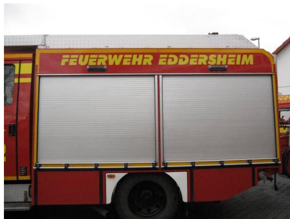
Aufbau „entrostet“ und mit Umfeldbeleuchtung in LED ausgestattet
