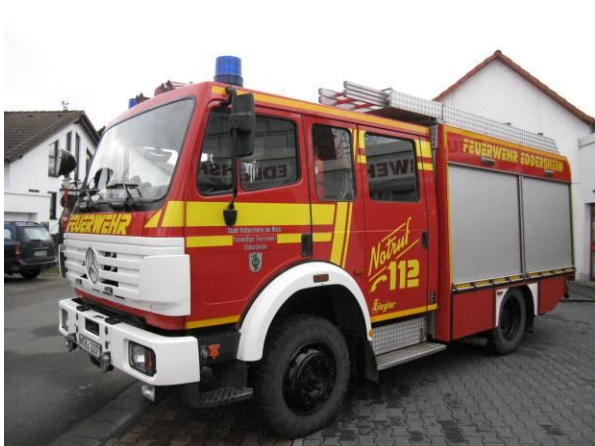
Aufbau „entrostet“ und mit Umfeldbeleuchtung in LED ausgestattet
